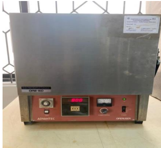
(d) Electric furnace
